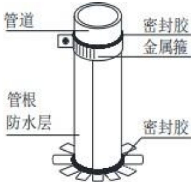
图3 出屋面管防水卷材固定密封
