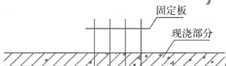
图 4 钢筋限位框使用示意图
