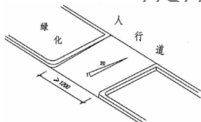
图 9.1.1-1 单面坡缘石坡道
