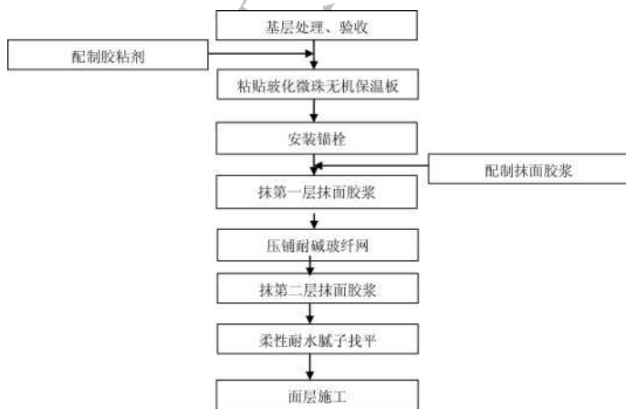
6.2.8 玻化微珠无机保温板薄抹灰外墙内保温系统施工工艺流程
