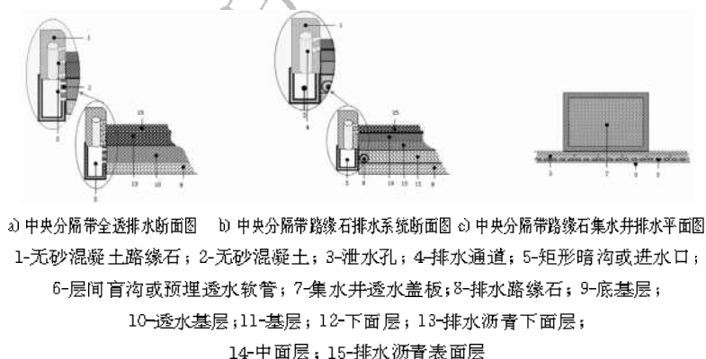
图 4.3.2-2 超高路段路缘石排水体系典型结构设计
