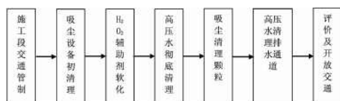
图 9.3.2 排水沥青路面功能恢复流程
