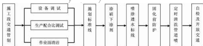
图 7.9.1 透水标线施工流程
