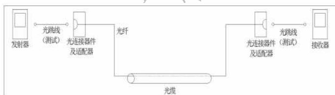
图 7.2.1 光纤链路测试连接图
