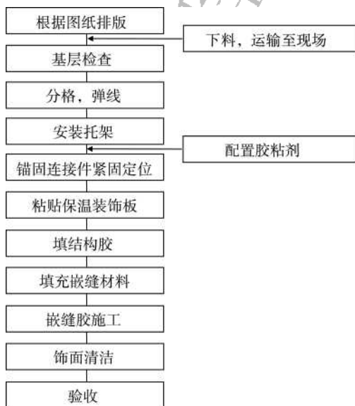
图 6.3.1 纤维增强改性发泡水泥保温装饰板外墙外保温系统施工工序
