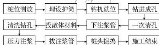
图 2 浆固散体材料桩施工流程
