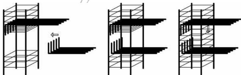
图 6.5.1 梁柱节点焊接箍筋安装示意图
