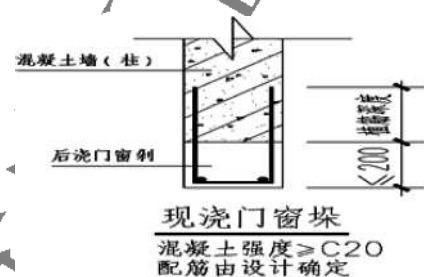
图 5.4.3 现浇门窗垛示意图
