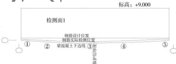
图 4.4.3-2 梁纵向钢筋位置现场检测示意图
