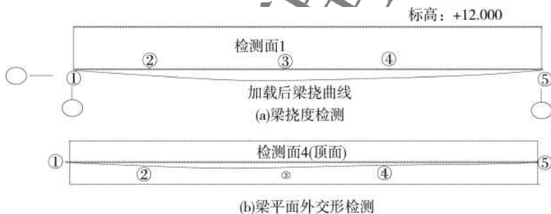
图 6.0.5-6 梁挠度及平面外形检测示意图
