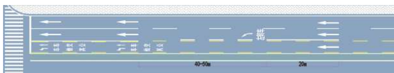
附图 A. 2-2 交叉口中央公交专用道进口车道设置示意图① (社会车辆直行车道数为 2 条)
