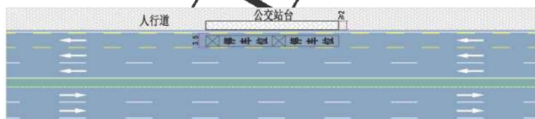
附图 B.5-1 直线式停靠车站的几何尺寸示意图(单位:m)
