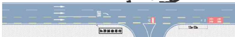
附图 D.2-2 宽度不小于 8m 的路口公交专用道设置示意图
