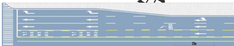
附图 A. 2-3 交叉口中央公交专用道进口车道设置示意图② (社会车辆直行车道数为 4 条)
