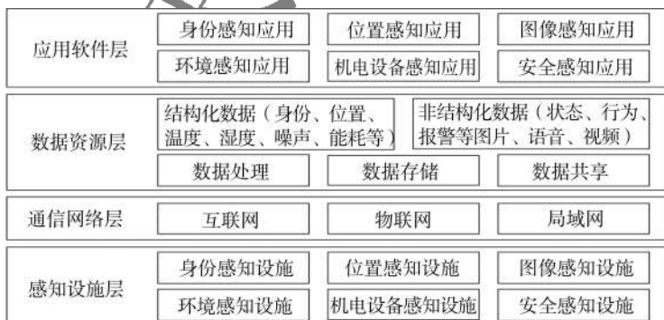
图 4.1.1 建筑智能感知系统架构图
