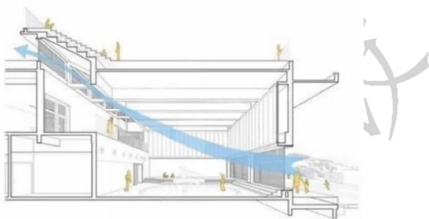
图 4.3.8 坡地建筑通风示意图
