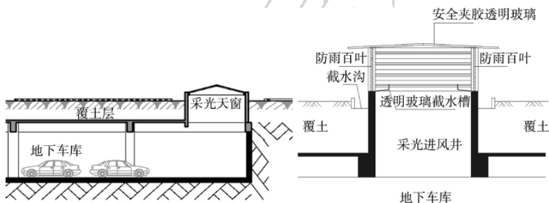
图 7-1 采光天窗、采光进风井设置示意图
