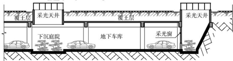
图 7-2 采光下沉天井设置示意图
