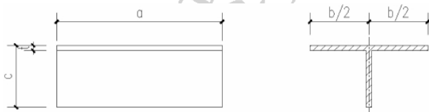
图 5.4.3.2-2 斜开槽插锚锚固连接件示意图
