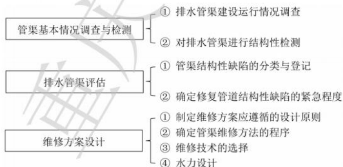
图 3.4.2 制定排水管渠维修方案程序
