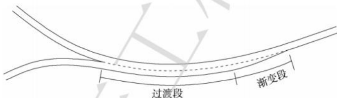
图 7.7.3-1 匝道合流车道平衡时增设过渡段
