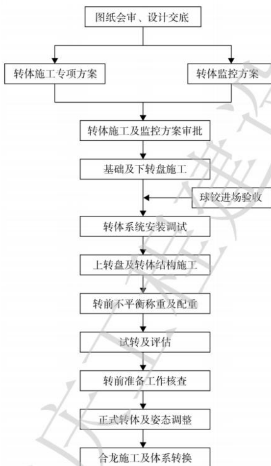
图 4.1.9 平转施工工作流程
