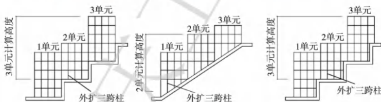
图 6 单元式多层住宅建筑单元计算高度图示
