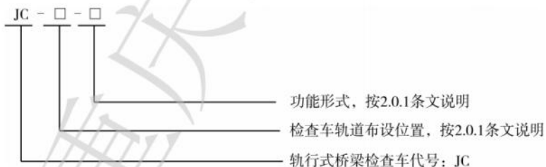
图 1 检查车型号表示方法
