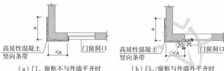
图 C.3.4-2 外墙阳角距洞口边距离小于 a 时竖向条带布置示意图
